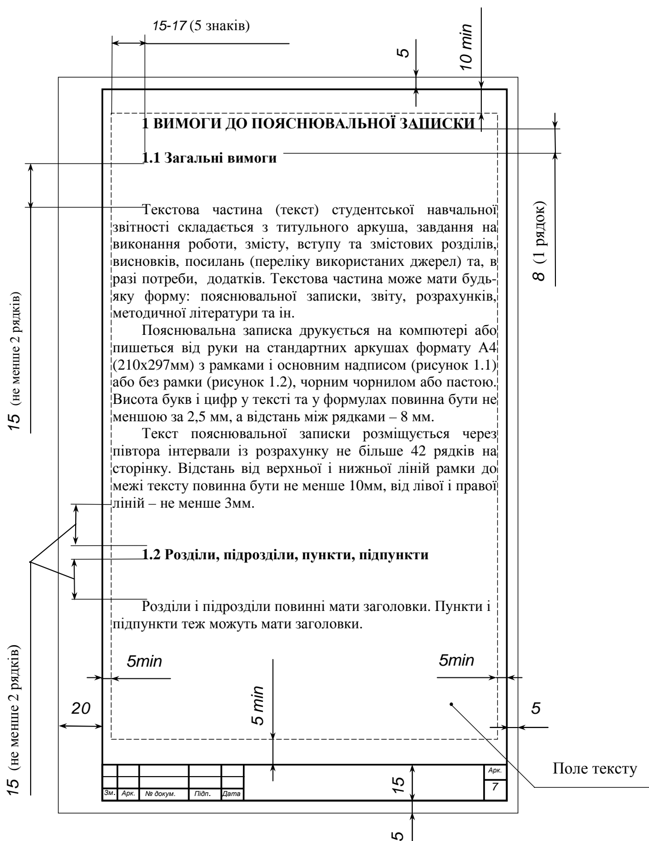
Рисунок 1.4 – Межі поля тексту на аркуші з рамкою та основним написом
